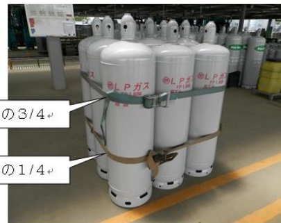
ラッシングベルトによる固定（例）
