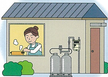
外壁などに設置
